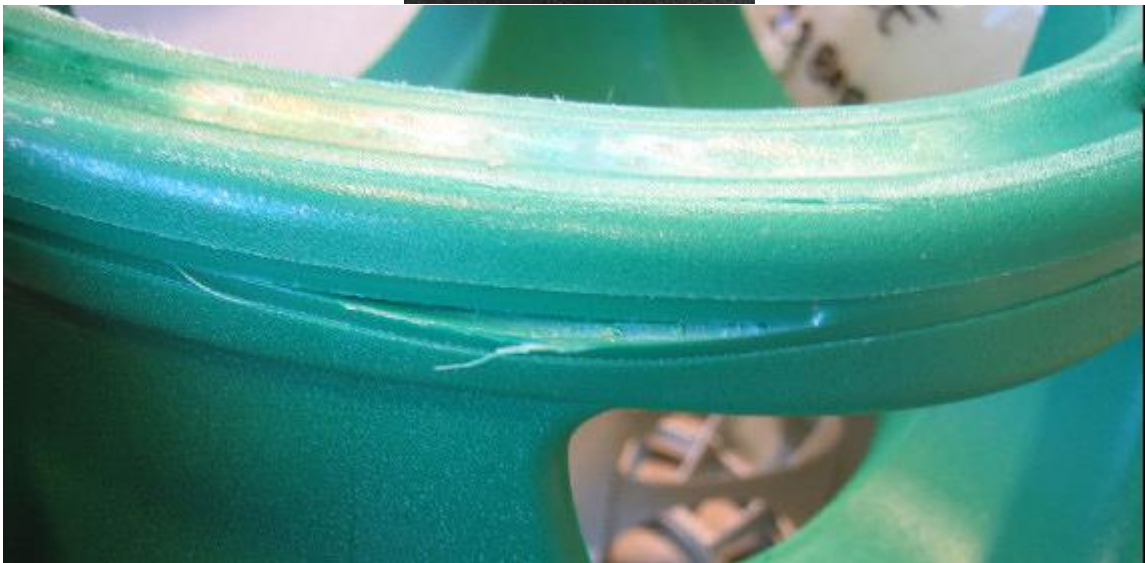
Figures 2 et 3 : Dommages à l'enveloppe extérieure - inacceptable
