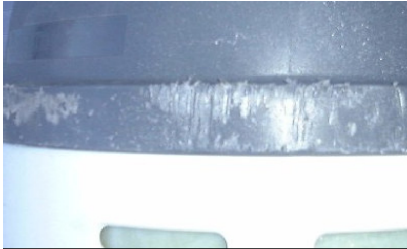
Figure 1: Dommages à l'enveloppe extérieure causé par abrasion - acceptable
