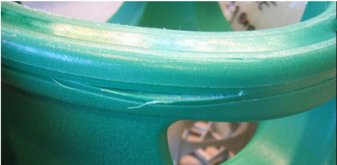
Figures 2 et 3 : Dommages à l'enveloppe extérieure - inacceptable
