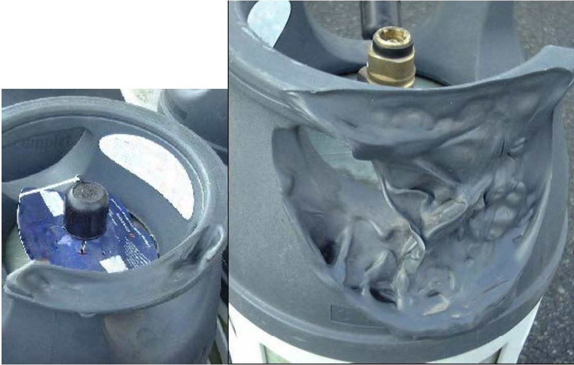
Figures 5 et 6 – Dommages à l'enveloppe extérieure causée par la chaleur – inacceptable
